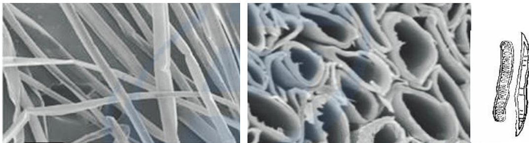
图 1-13 木棉纤维的纤维形态
