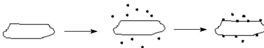
图 3-53 滑石粉片晶对树脂胶粒的吸附
